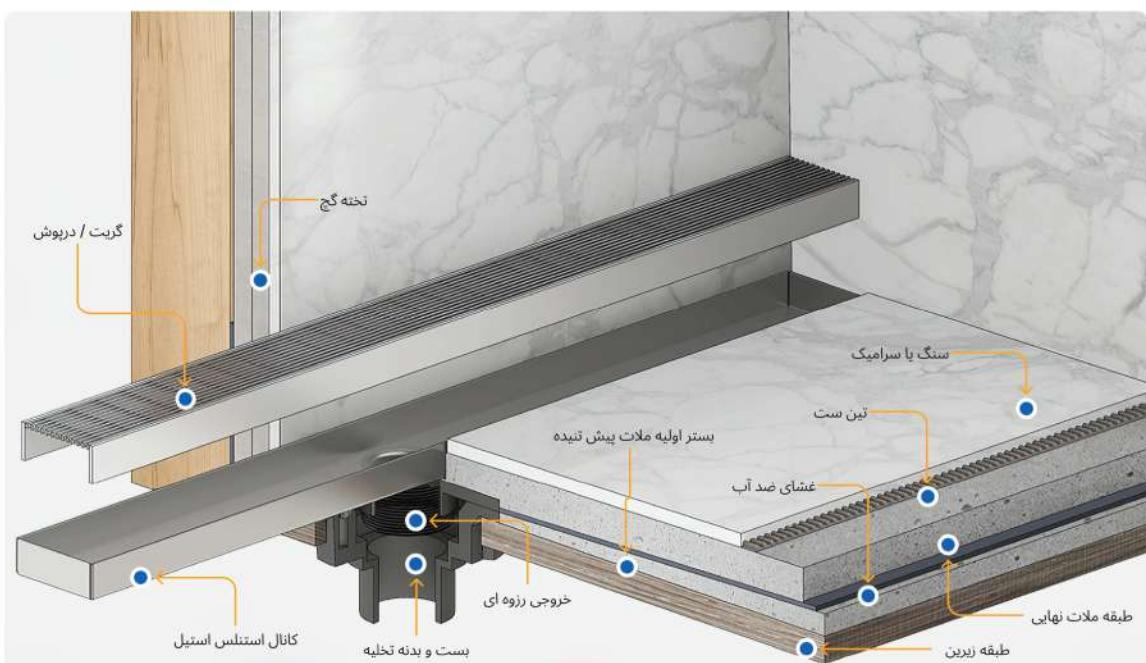
این زهکش‌ها از یک فرورفتگی مستطیلی شکل بلند با شکاف یا گریت باریک در امتداد قسمت بالایی تشکیل شده است. این شکاف به آب اجازه می دهد تا در حین جمع کردن زباله‌های بزرگتر به داخل زهکش جریان یابد. کفسور خطی به دلیل جذابیت زیبایی شناختی محبوب هستند، زیرا می توانند به طراحی شیک و مدرن حمام کمک کنند.
