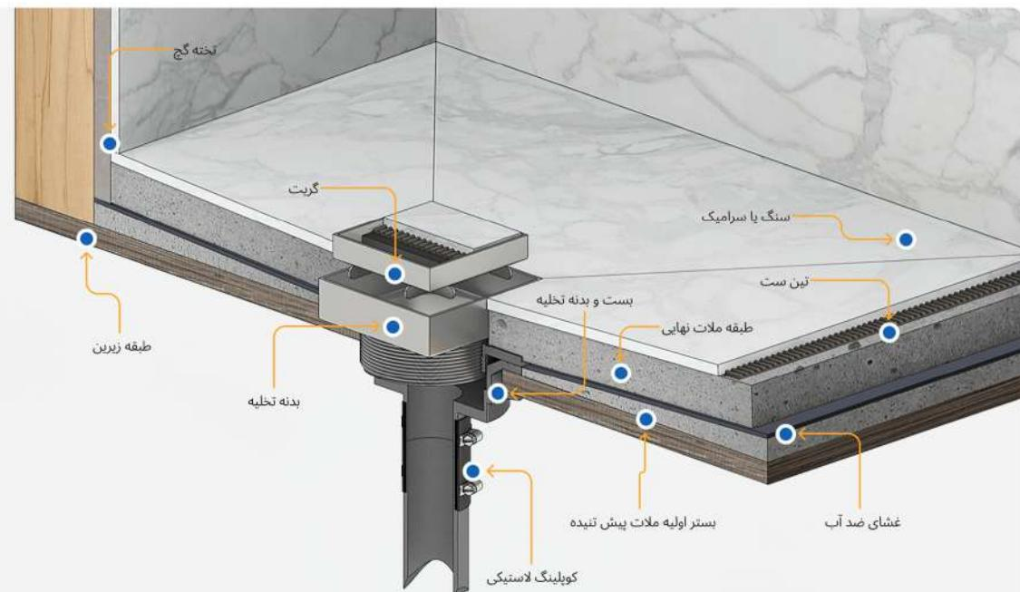
شكل نقطه ای اغلب به دلایل کاربردی و زیبایی شناختی انتخاب می شود. از نظر عملکردی، به جلوگیری از جمع شدن آب در مناطق خاصی از حمام کمک می کند و تضمین می کند که آب به طور موثر تخلیه می شود. از نظر زیبایی شناختی، طراحی نقطه ای می تواند در مقایسه با یک پوشش صاف یا استاندارد زهکشی از نظر بصری جذاب تر باشد و سبکی را به طراحی کلی دوش اضافه کند.
